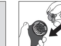
⑤ホッパーの下から④で組んだ内臼をセットし、粗さ調整つまみを時計回りに締めて装着完了です。
